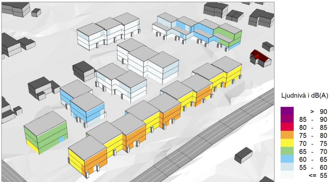
Figur 6. Maximal ljudnivå (frifältsvärde) vid fasad från vägtrafik för prognosår 2040. Vy från sydost.
